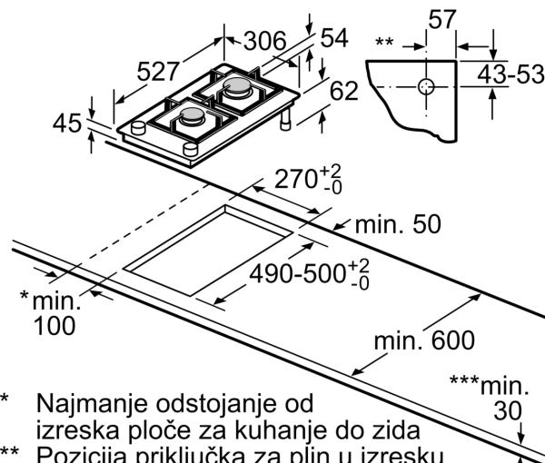
\* Najmanje odstojanje od izreska ploče za kuhanje do zida
