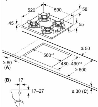
**A:** Min. udaljenost od otvora za ploču za kuhanje do zida
