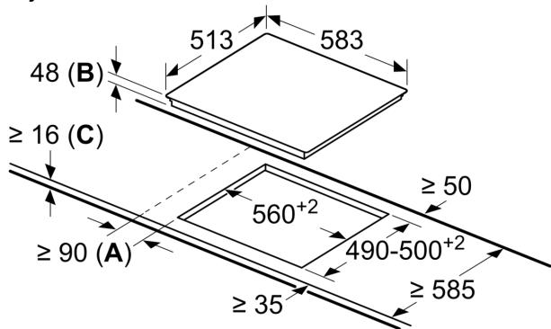
**A:** Minimalna udaljenost od izreza ploče do zida.
