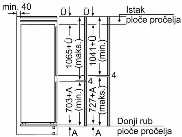
Navedene mjere vrata elementa vrijede za procjep vrata od 4 mm.
