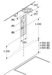
A: Sortie d'air B: Prise C: Électrique D: Gaz - depuis le bord supérieur du support casserole E: Électrique - pour l'Australie et la Nouvelle-Zélande
