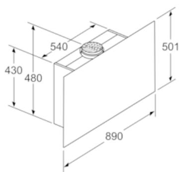
Appareil en mode circulation d'air sans canal
