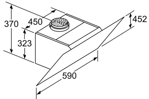
Appareil en mode circulation d'air sans canal
