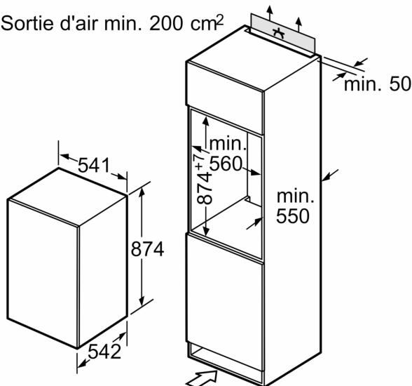
Ventilation dans le socle min.  $200 \text{ cm}^2$
