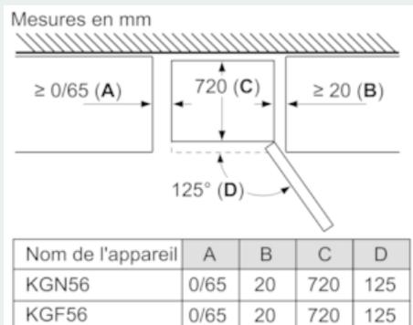
A : pour les modèles équipés de poignées intégrées verticalement, une distance minimale de 65 mm est requise pour une ouverture aisée.
