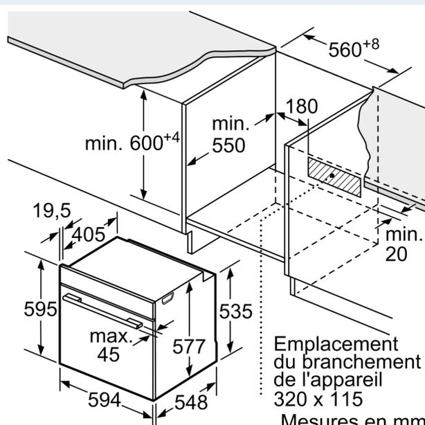
Emplacement du branchement de l'appareil
