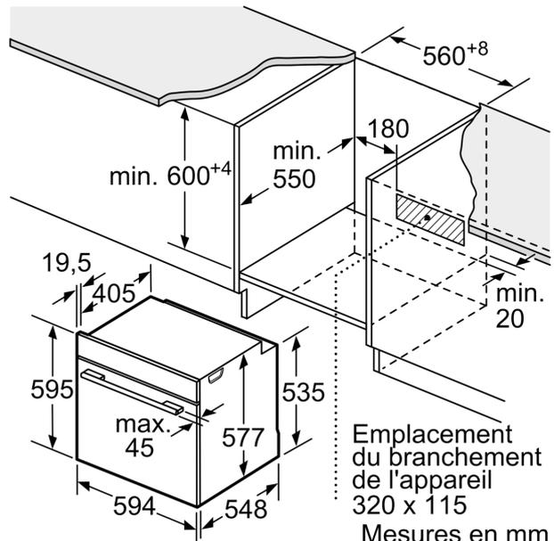
Emplacement du branchement de l'appareil
