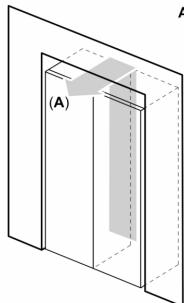
A: Sortie d'air  $\geq 200 \text{ cm}^2$
