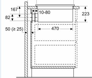
En cas d'installation directement contre des murs extérieurs qui ne sont pas isolés ( $\mu \geq 0,5 \text{ W/m}^2\text{°C}$ ), nous recommandons d'utiliser des configurations de recyclage partiellement ou totalement gainées.
