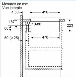
En cas d'installation directement contre des murs extérieurs qui ne sont pas isolés ( $\mu \geq 0,5 \text{ W/m}^2 \cdot \text{C}$ ), nous recommandons d'utiliser des configurations de recyclage partiellement ou totalement gainées.
