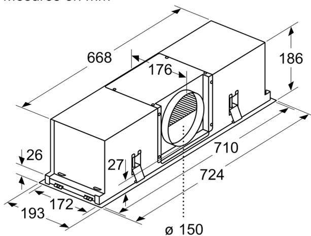
Le manchon de raccordement peut être déplacé en fonction de la situation d'installation
