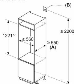
A:  $\geq 560 \text{ mm}$  (recommandé)
