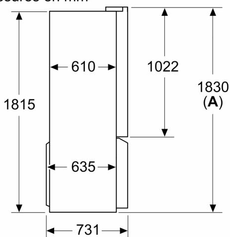
**A:** La façade est réglable de 1830–1847 mm, avec les pieds de nivellement ayant à sortie totale
