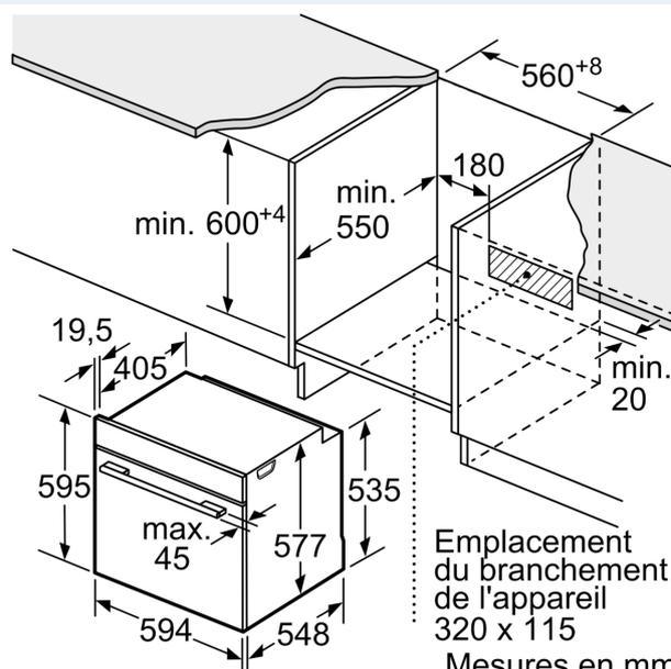
Emplacement du branchement de l'appareil
