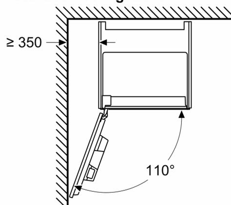
En cas d'utilisation du limiteur de charnière à 92°, la distance min. au mur est uniquement de 100 mm
