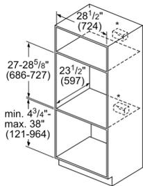
\* Pour des fours individuels installés dans une armoire murale, le boîtier de raccordement peut se situer au-dessus ou au-dessous de l'unité à portée du caniveau de câbles.
