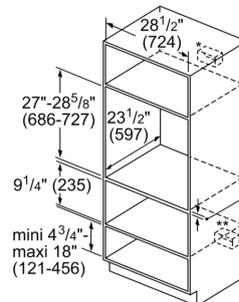
\*Four mural-La prise peut être placée au-dessus ou à droite ou à gauche de l'unité, à proximité de la ligne d'alimentation.
