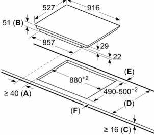
**A:** Distance minimum entre la découpe de la plaque de cuisson et le mur.
