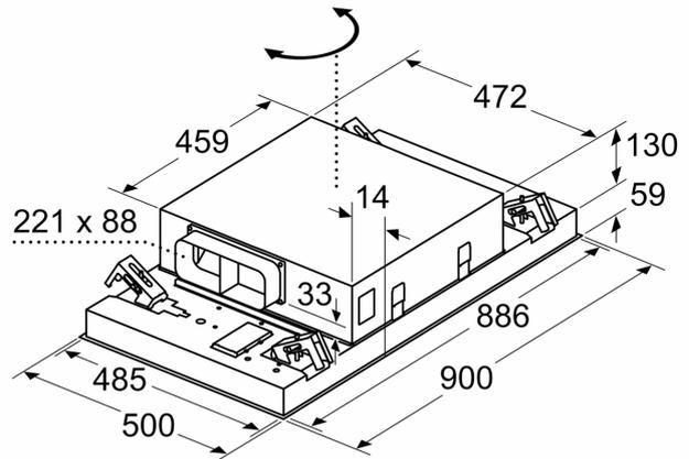
La sortie du ventilateur peut être tournée dans les quatre directions
