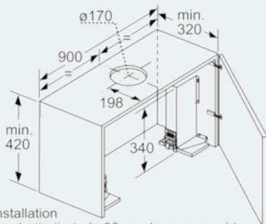
L'installation d'une hotte tiroir de 90 cm dans un meuble haut d'une largeur de 90 cm requiert un kit d'installation. Les deux équerres d'installation sont vissées à droite et à gauche dans le meuble. Installation selon gabarit.
