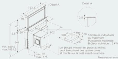
Le groupe moteur est placé au milieu, peut être pivoté des quatre côtés et monté sur la côté avant ou arrière.
