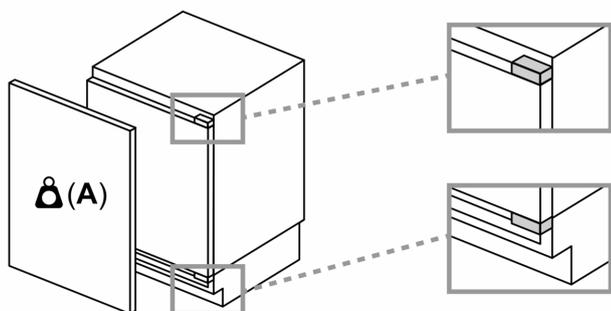
Les façades d'appareils montés qui dépassent le poids autorisé peuvent provoquer des dommages et entraîner un dysfonctionnement des charnières
