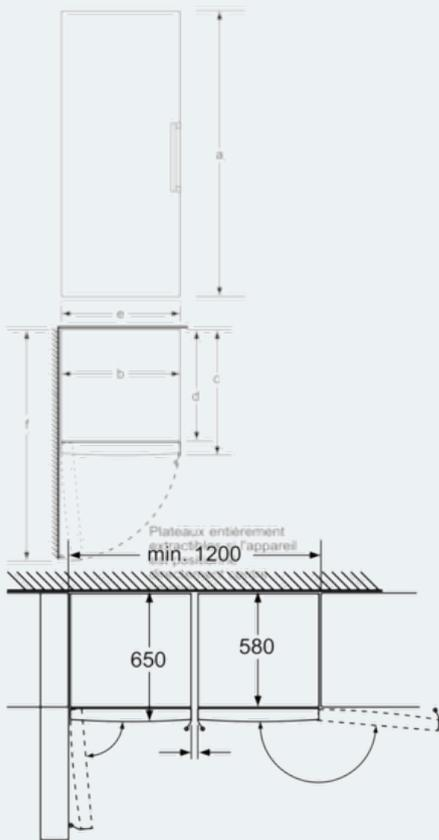
Panels entièrement amovibles lorsque l'appareil est directement placé sur un mur. Mesures en mm
