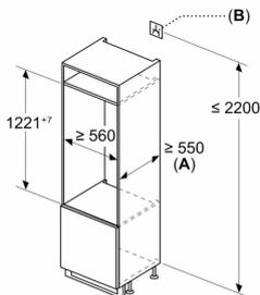
A:  $\geq 560 \text{ mm}$  (recommandé)
