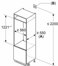
A:  $\geq 560 \text{ mm}$  (recommandé)
