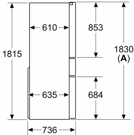
**A:** La façade est réglable de 1830 à 1847 mm, avec les pieds de nivellement avant à sortie totale
