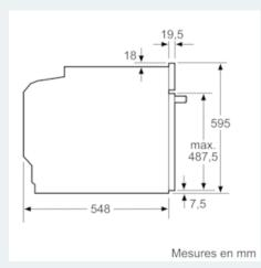
Si l'appareil est installé sous une table de cuisson, les épaisseurs de plaque de travail suivantes (le cas échéant y compris la sous-structure) doivent être respectées.
