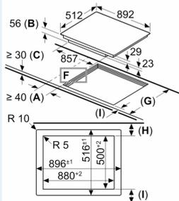
A: Distance minimum entre la découpe de la plaque de cuisson et le mur.
