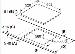
A: Distance minimum entre la découpe de la plaque de cuisson et le mur.
