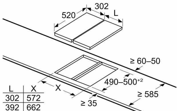
Si deux éléments ou plus sont installés côte à côte, un ou plusieurs kits d'installation sont nécessaires (2 éléments 1 kit d'installation, 3 éléments 2 kits d'installation, etc.)
