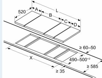
Si deux éléments ou plus sont installés côte à côte, un ou plusieurs kits d'installation sont nécessaires (2 éléments 1 kit d'installation, 3 éléments 2 kits d'installation, etc.)
