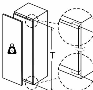
Paigaldatud lubatust suurema kaaluga mööbliuksed võivad hingest vigastada ja mõjutada nende talitlust.
