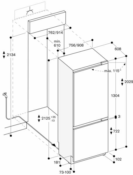
Las dimensiones máximas del frontal de la puerta están diseñadas para una holgura de 3 mm.
