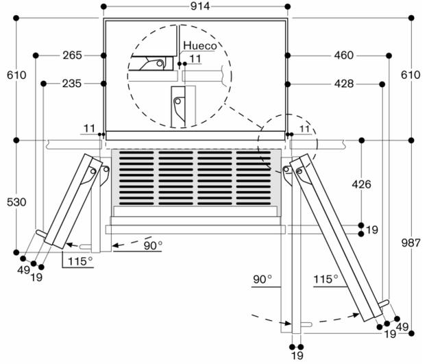
En el plano se ha tomado como base un grosor frontal del mueble de 19 mm y la altura de un tirador de mueble de Gaggenau de 49 mm.
