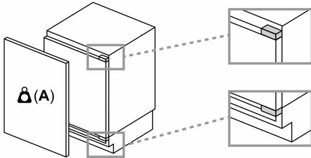
Los frontales instalados en la unidad que superen el peso permitido pueden causar daños y afectar al funcionamiento de las bisagras
