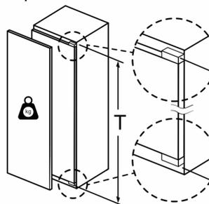
Las puertas del mueble montadas que exceden el peso permitido pueden provocar daños y deterioro funcional a la bisagra.
