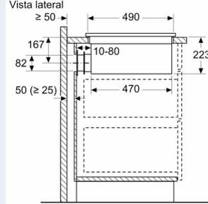
Al realizar la instalación directamente en paredes exteriores no aisladas ( $\mu \geq 0,5 \text{ W/m}^2\text{°C}$ ), recomendamos el uso de configuraciones de recirculación total o parcialmente canalizada.
