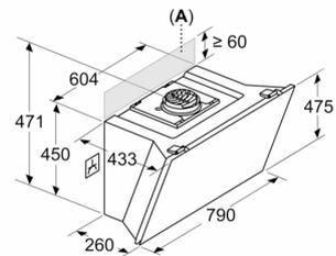
El enchufe puede instalarse en el costado o en la parte superior del aparato
