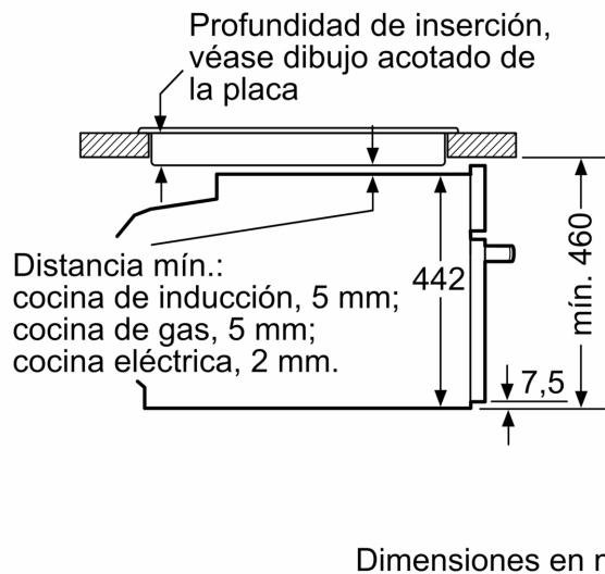
Si se instala el aparato compacto debajo de una placa, se debe respetar el siguiente grosor de encimera (incl., dado el caso, la estructura de soporte).
