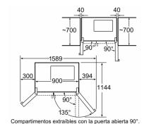
Compartimentos extraíbles con la puerta abierta 90°. Compartimentos extraíbles con la puerta completamente abierta. Dimensiones en mm
