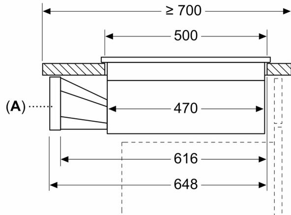
A: Adaptador cilíndrico/plano
