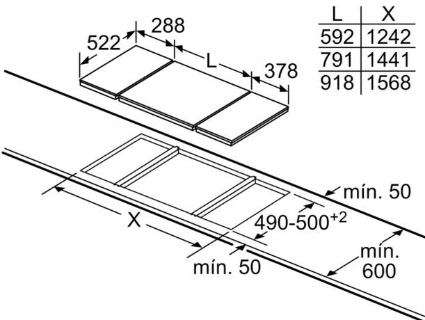
Para el montaje de dos encimeras dominó adosadas a una abertura se requieren dos juegos de montaje (3AB3030L).
