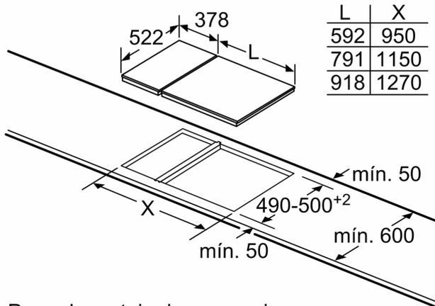
Para el montaje de una encimera dominó adosada a una abertura se requiere un juego de montaje (3AB3030L).
