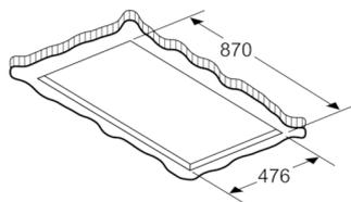
Para fijar la campana extractora se requiere una estructura inferior apta y resistente. No montar el aparato directamente sobre tablas de yeso o materiales ligeros similares.
