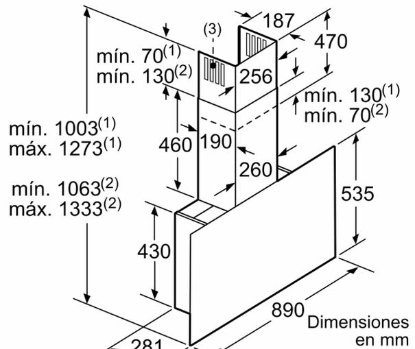
(1) Salida de aire al exterior (2) Circulación de aire
