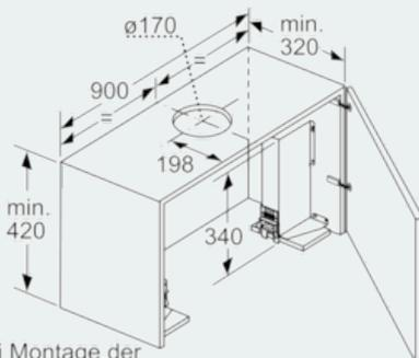
Bei Montage der 90cm Flachschirmhaube in einen 90cm breiten Oberschrank ist ein Montage-Set erforderlich. Die beiden Montagewinkel werden rechts und links im Möbel verschraubt. Montage nach Schablone. Maße in mm
