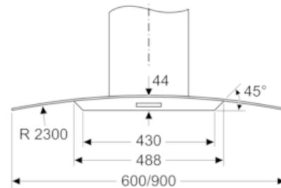
Maße für die Auslegung von Rückwandpaneelen. Bitte beachten, dass alle Maße Toleranzen unterliegen. Die tatsächlichen Maße sind am vorhandenen Gerät zu überprüfen.
