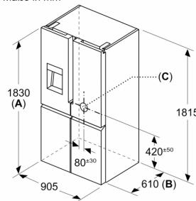
**A:** Front ist von 1830–1847 mm, bei voll ausgezogenen vorderen Nivellierfüßen, verstellbar
