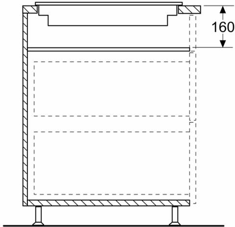
Unter dem Gerät muss ein Zwischenboden entsprechend der Montagezeichnung montiert werden
