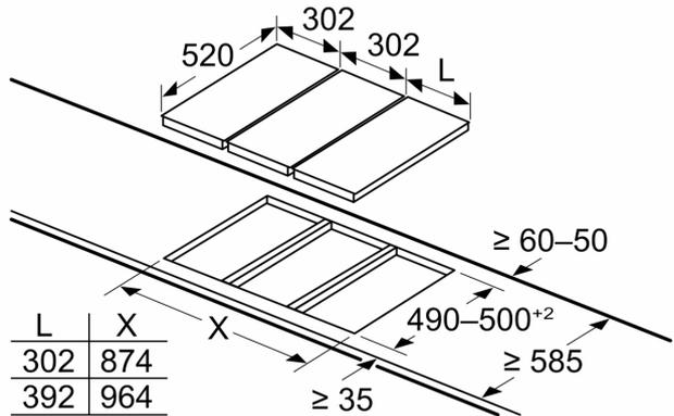
Bei Einbau von zwei oder mehr Elementen nebeneinander sind ein oder mehrere Montagesätze erforderlich (2 Elemente = 1 Montagesatz, 3 Elemente = 2 Montagesätze usw.)
