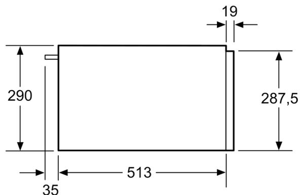
Über eine Wärmeschublade können Backöfen mit einer Gerätehöhe von 595 mm eingebaut werden. Ein Zwischenboden ist nicht erforderlich.
